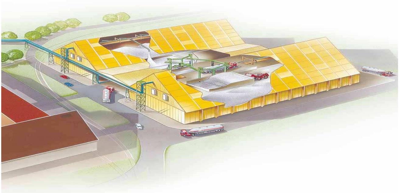
**Imagen 15.** Diseño de un silo horizontal. Fuente: FL automatitacion.
