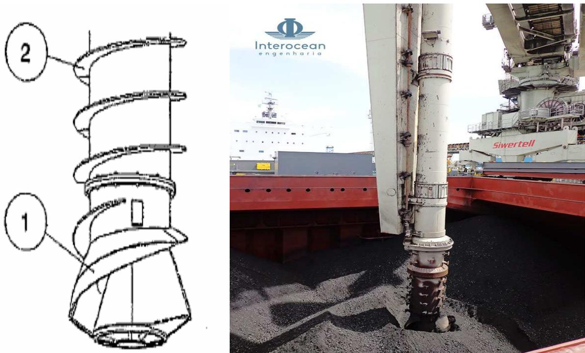
Imagen 21. Detalle de un descargador Siwertell. Fuente: [www.interocean-rj.com](http://www.interocean-rj.com).
