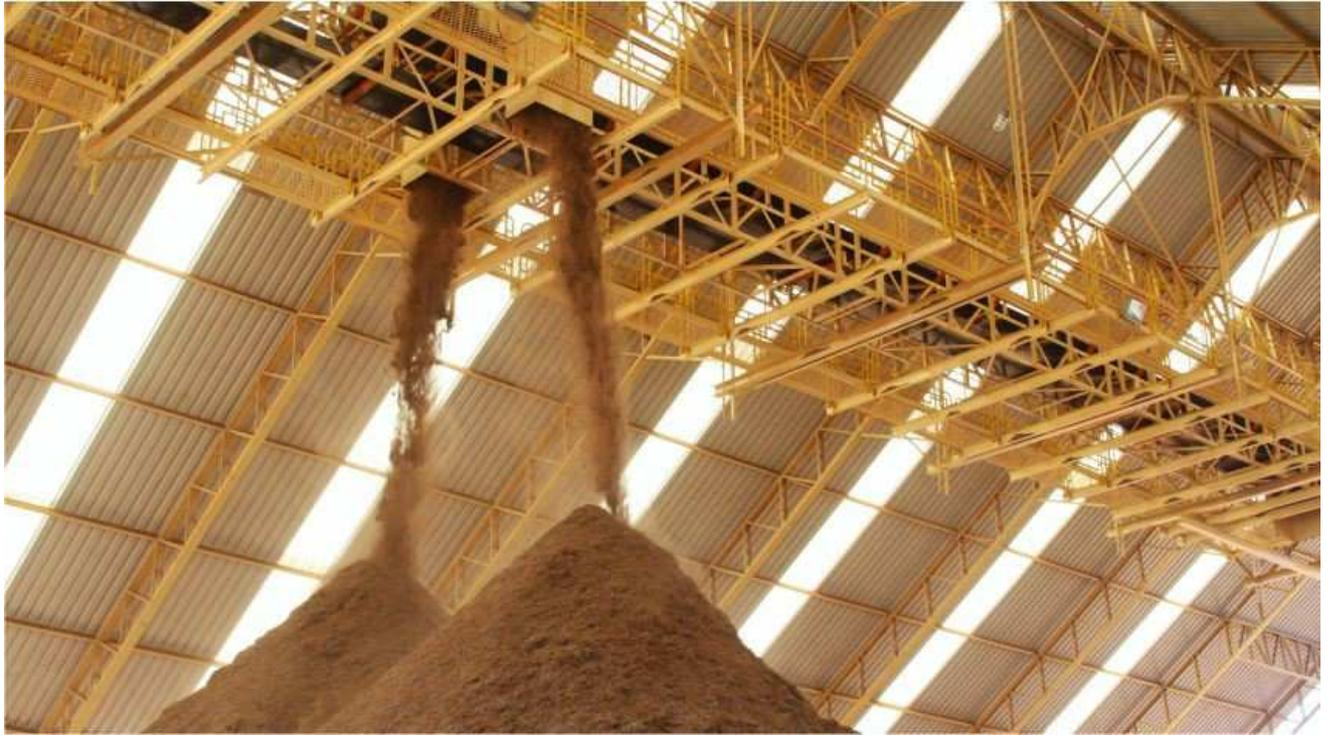
**Imagen 14.** Silo horizontal con carga superior. Fuente: <http://www.lippel.com.br/es/unidades-de-produccion/unidades-de-produccion/patio-de-chips.html#.VfmAFaTosiE>.
