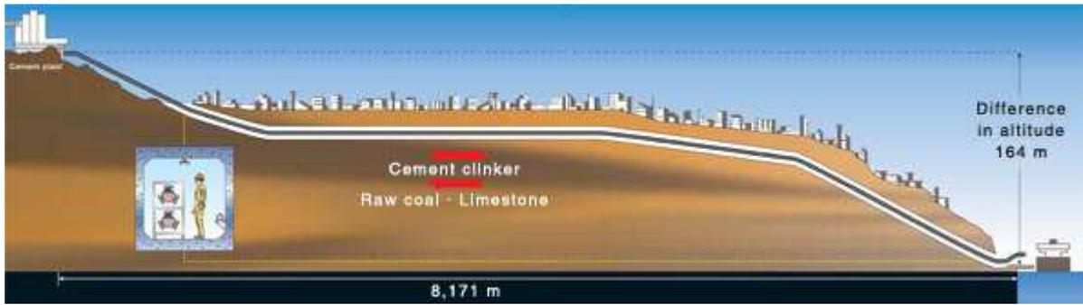
Imagen 32. Banda transportadora tubular. Fuente: www.phoenix-conveyorbelt.com.
