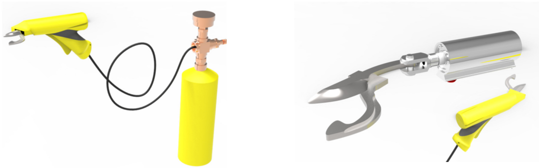
Figura 8.47 Herramienta neumática con su tanque de compresión que puede cargarse a la espalda.
