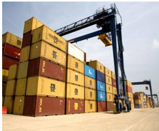
Figura 13. Grúas RTG en el puerto de Cartagena Fuente: (Sociedad Portuaria Regional de Cartagena, S.A., 2015)
