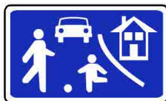
Figura C.16. Señal de tráfico S-28 de calle residencial.
