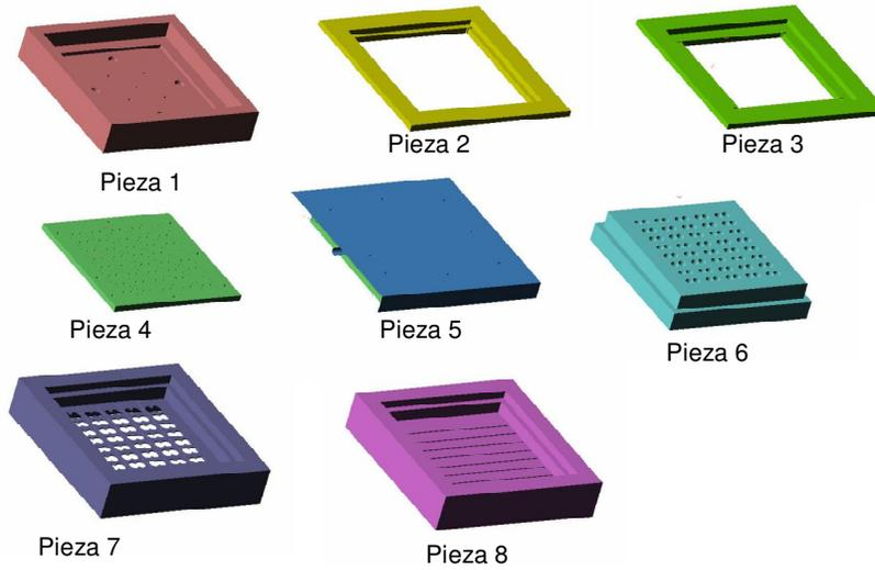
**Figura C.1 Modelos de las herramientas.** Aquí se presentan el diseño en 3D de las piezas de aluminio para el cortado de las piezas poliméricas.
