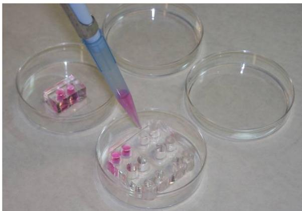
**Figura 3.15 Fotografía de 1 par de pozos y 6 pares de pozos.** Estos bloques son formas alternativas en que puede ser cortada la matriz de PDMS. En una placa de Petri de 35 mm de diámetro cabe un bloque de silicona de 1 par de pozos (no se muestra en la imagen) y en una placa de Petri de 60 mm de diámetro cabe un bloque con 6 pares de pozos.
