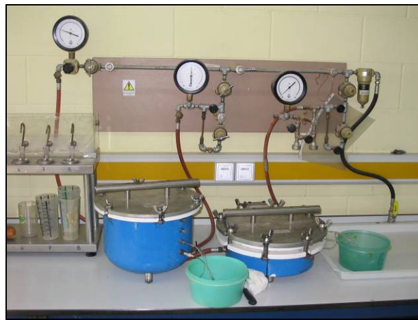
Figura IV 6. Placas de presión Richards utilizadas para la determinación de la curva característica de humedad de las clases texturales representativas de la parcela experimental.
