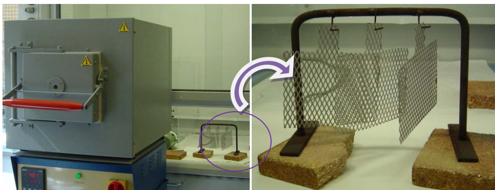
Figura 6. Mufla i elèctrodes sintetitzats de Ti/SnO 2 -Sb-Pt.
