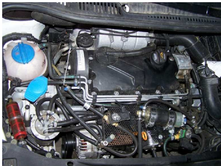
Figura 4.1 Motor d'un vehicle convencional modificat per funcionar amb oli vegetal.
