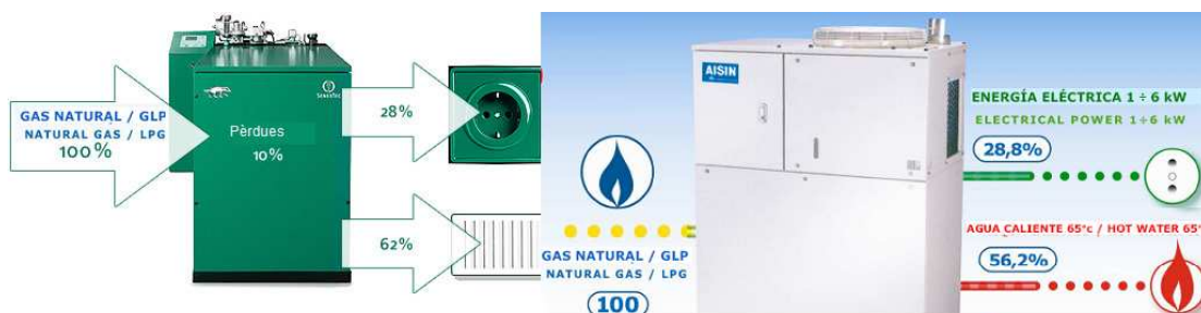
Figura 4.4.23. Esquema d'equips de microcogeneració. Font; Catàlegs Toyota i Baxi-Roca
