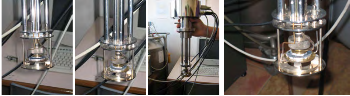
Figura 4.15 - 4.16. -4.17 -4.18.- Fotografía de los electrodos del DEA con la muestra polimérica.
