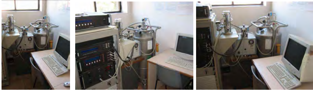
Figura 4.19. -4.20 -4.21.- Equipo DEA utilizado, con el ordenador utilizado para tratamiento y almacenamiento de datos y equipo de nitrógeno líquido para realizar estudios a muy bajas temperaturas. Equipo cedido por el grupo de investigación de física de los dieléctricos de la ETSEIAT (Dilab)
