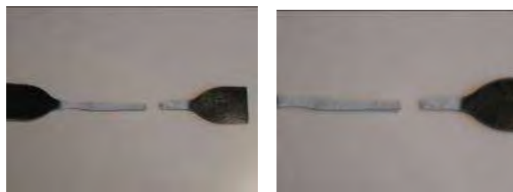
Figura 4.34.- 4.35. - Imágenes del resultado del ensayo tracción deformación. Se aplica una fuerza a la probeta hasta que ésta rompe
