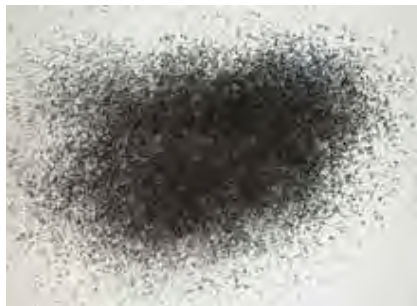
Fig. 3.12.- Polvo de GTR de tamaño comprendido entre 200 y 500 µm
