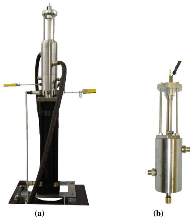
**Fig. 48:** (a) Unidad experimental para el cálculo del coeficiente de descarga. (b) Detalle del pistón obturador y del sensor de desplazamiento
