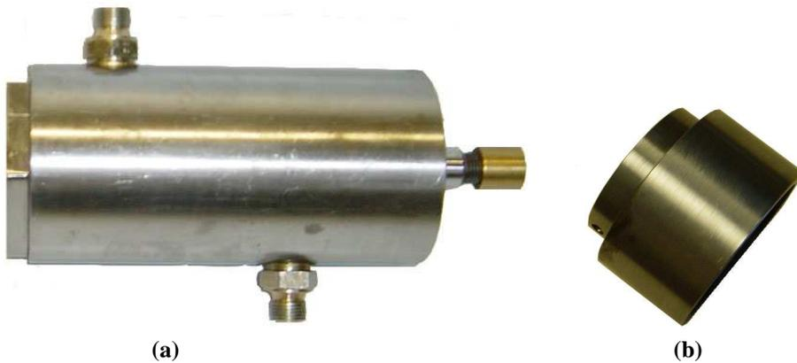
**Fig. 47:** (a) Pistón oleohidráulico utilizado en la prueba de determinación del coeficiente de descarga. (b) Tapa superior de la unidad experimental.
