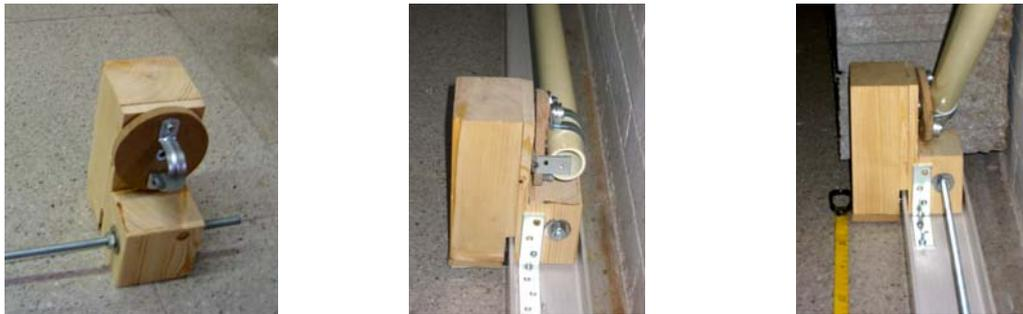
Figura N° II-19: Diseño del dispositivo para la aplicación de la tensión
