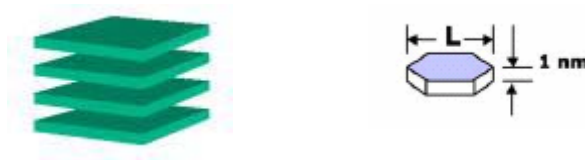
Figura 1.1. Representación esquemática de la estructura general de una partícula de un compuesto laminar apilado y detalle de una laminilla.
