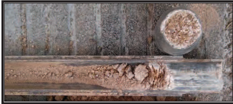
Granit alterat de la capa B recuperat en un assaig de SPT.
