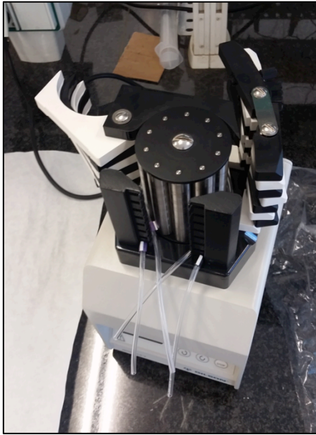
Figura 28 : Detalle de la bomba peristáltica
