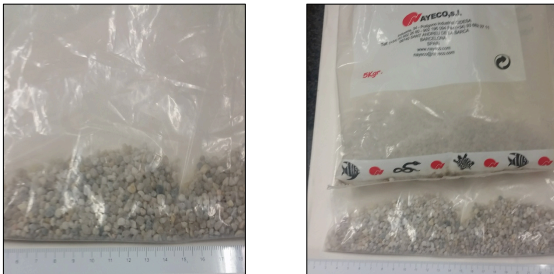
Figura 5: Características visuales de la arena y gravilla utilizadas como relleno de las columnas de ensayo
