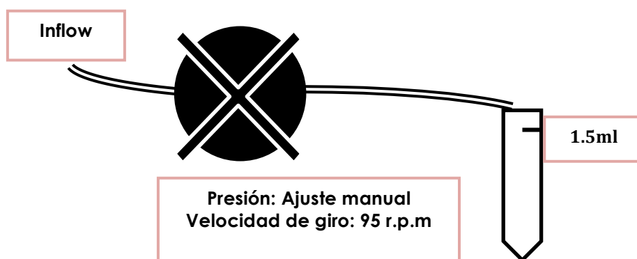
Figura 8: Esquema de ajuste de presión de las pestañas de la bomba mediante cálculo de caudal a la salida del sistema
