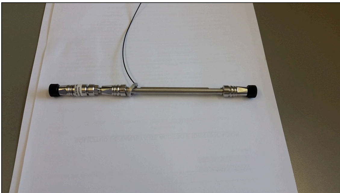
Figura 33: Columna utilizada para el análisis químico con Orbitrap. Merck
