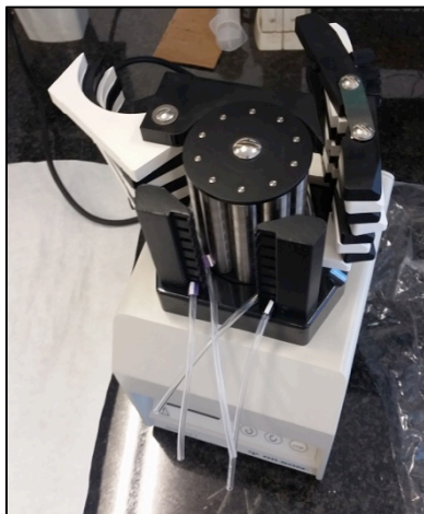
Figura 7: Bomba peristáltica Minipuls 3, Gilson
