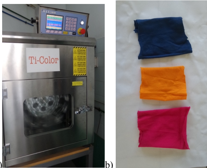
Ilustración 3-8 a) Equipo empleado para la realización de las tinturas. b) Telas teñidas terminadas con (de arriba para abajo) Navy, Yellow y Crimson.
