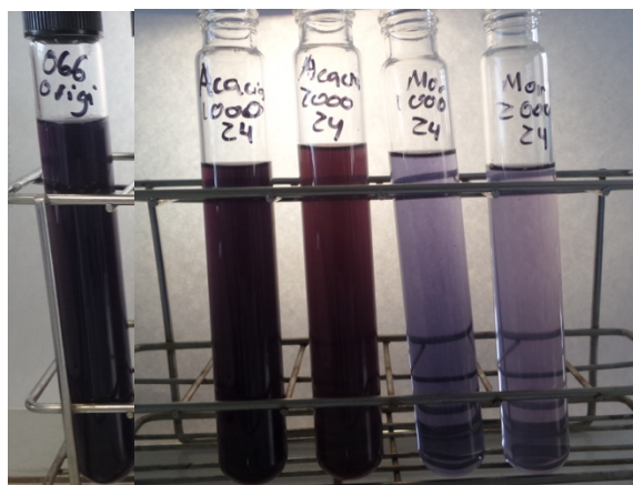
Ilustración 3-37 Muestras L-066-16 tratadas 24h (De izquierda a derecha) Muestra original, Acacia 1000 ppm, Acacia 2000 ppm, Moringa 1000 ppm, Moringa 2000 ppm.
