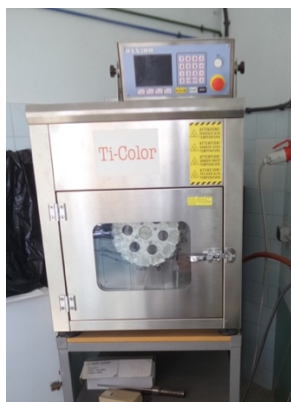
Ilustración 2-14 Equipo Ti-color OTX200, con capacidad de 12 racionales tubulares individuales de acero inoxidable para la tintura de 100 ml, empleando un método “all in”.
