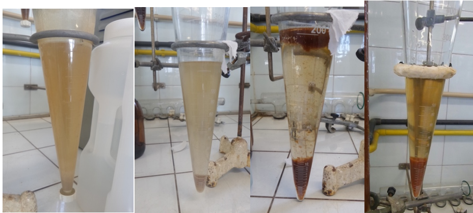
Ilustración 3-20 Tratamiento de la muestra L-061-16 con (de izquierda a derecha) 1000 ppm de Moringa O.; 2000 ppm de Moringa O., 1000 ppm de Acacia; 2000 ppm de Acacia; 1000 ppm de FeCl 3 , a 30 minutos.
