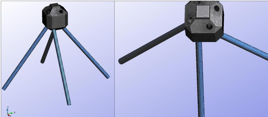
Fig. 2.5. Mallado del Piloedre en GiD (dos perspectivas diferentes).
