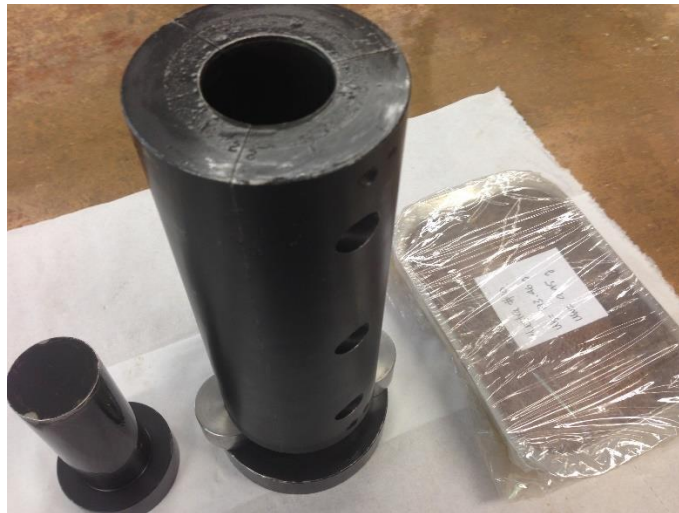
Figura 33. Molde engrasado, listo para recibir material
