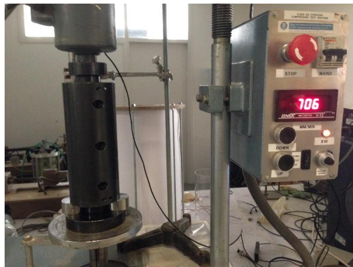
Figura 38. Compactación en marcha
