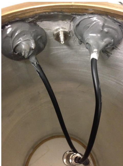
Figura 50. Parte interna de la cámara con 3 puertos. Uno para LVDT y dos para la columna resonante
