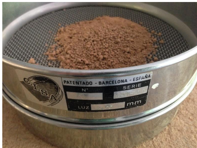
Figura 23. Tamiz número 10, abertura de 2 mm
