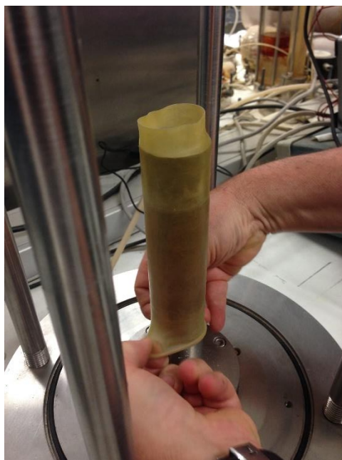
Figura 47. Colocación de la membrana elástica sobre la probeta
