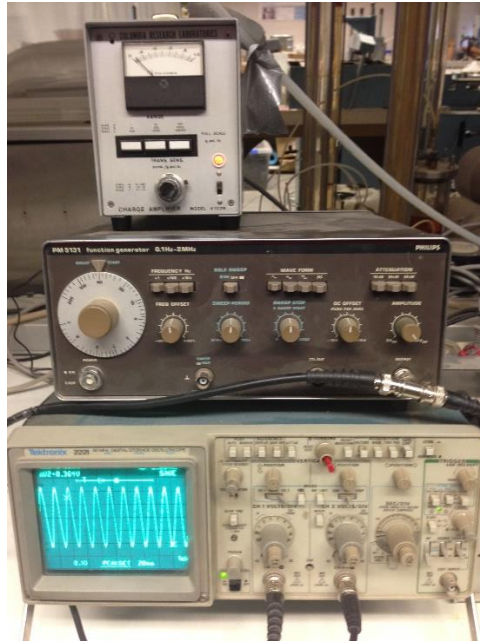
Figura 57. Partes del equipo de columna resonante. De arriba a abajo: acelerómetro, generador y osciloscopio
