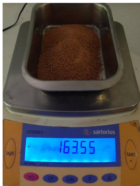
Figura 26. Material seco de una probeta con densidad de 1.65 \text{ Mg/m}^3 , más 15% de abundamiento
