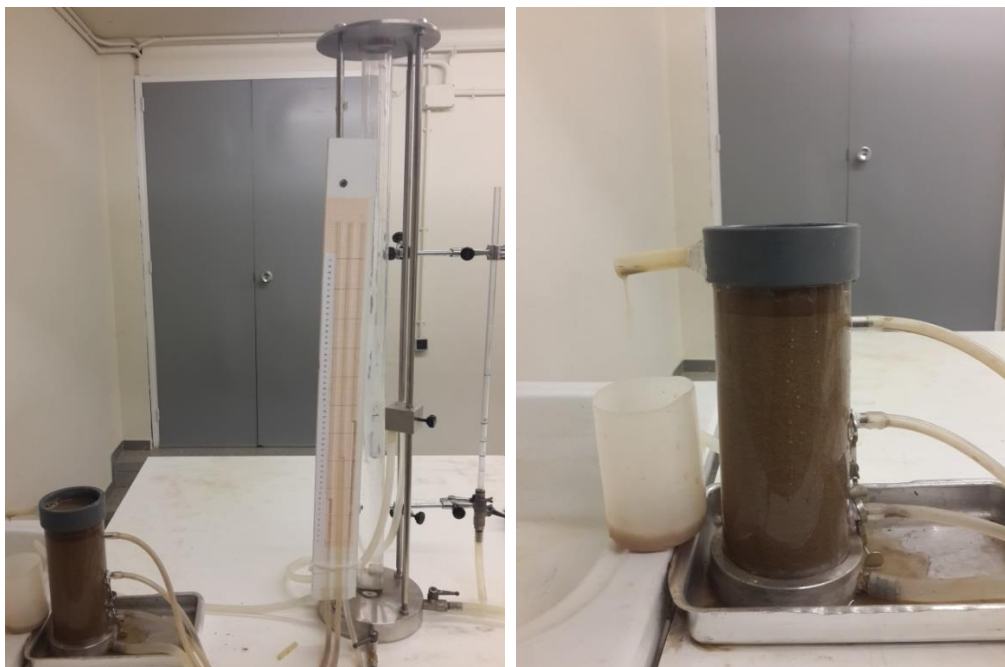
Figura 9 - Fotografía tomada del equipo de permeabilidad de carga constante UPC. Fuente: Propia.
