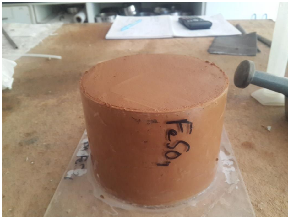
Figura 20 - Suelo rojo de Barcelona con una saturación de 51% dentro de un recipiente de metacrilato. Fuente: Propia.
