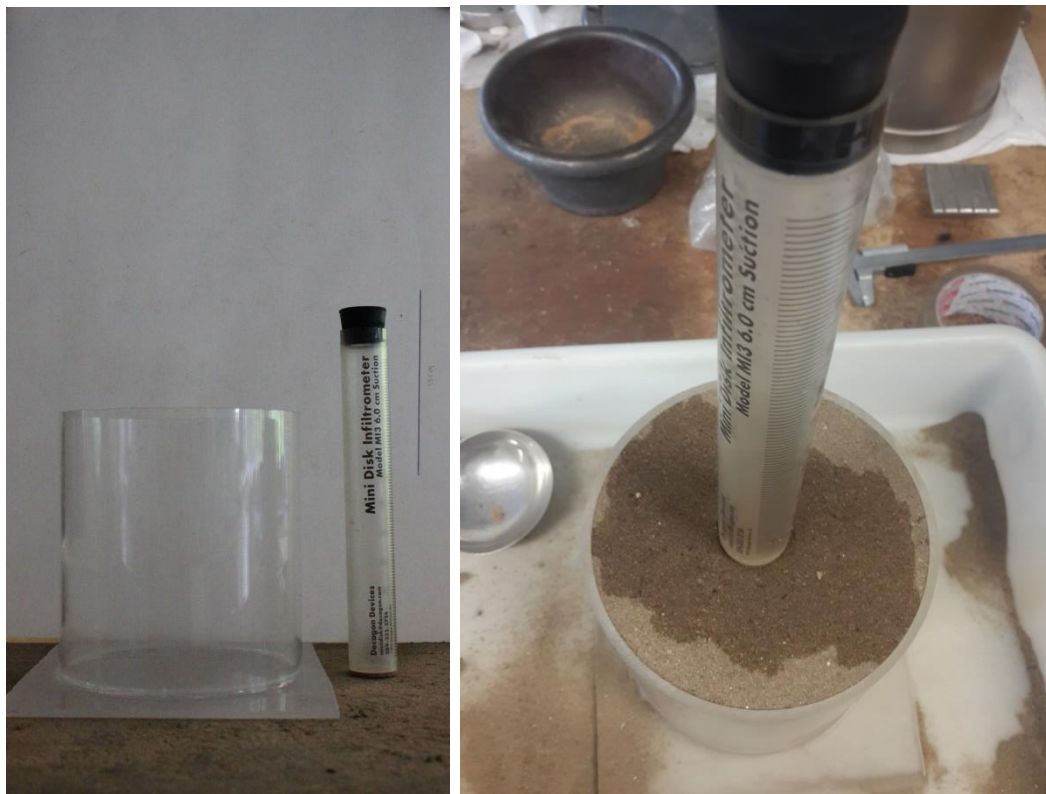
Figura 19 - Fotografía del infiltrómetro y recipiente de metacrilato utilizado para los ensayos de infiltración en la arena. Fuente: Propia
