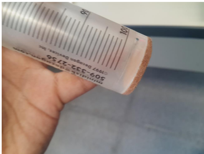
Figura 18 - Fotografía del capilar y disco poroso del infiltrómetro de succión utilizado en los ensayos. Fuente: propia.
