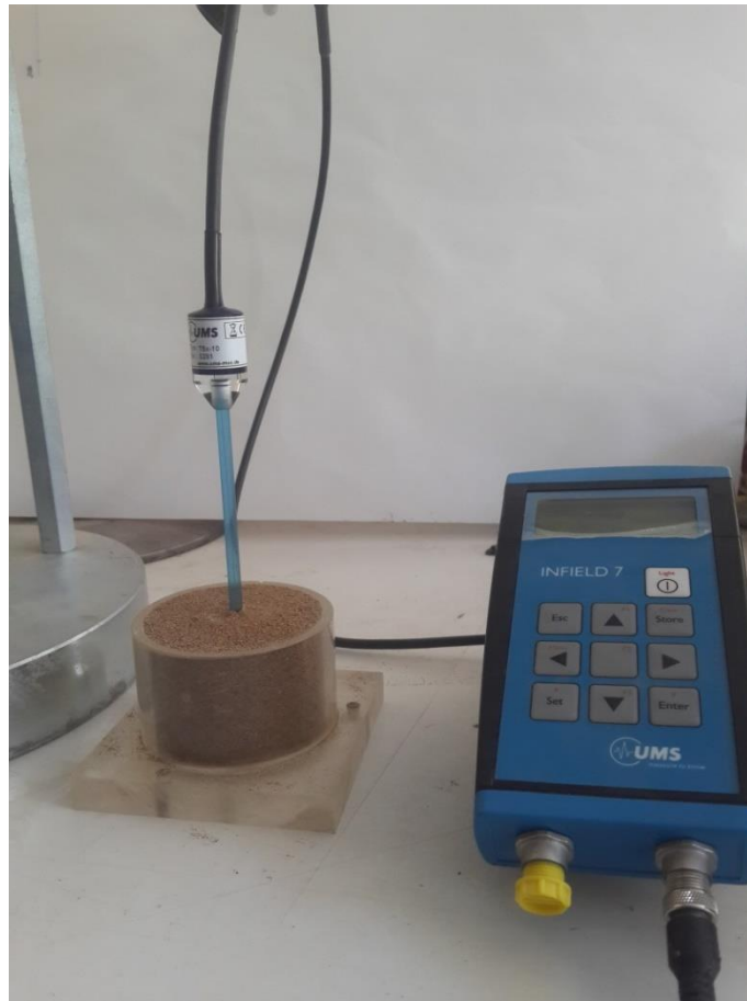
Figura 11 - Composición del equipo de medición de succión, tensiómetro T5 (UMS) e Infield 7 (UMS). Fuente: Propia
