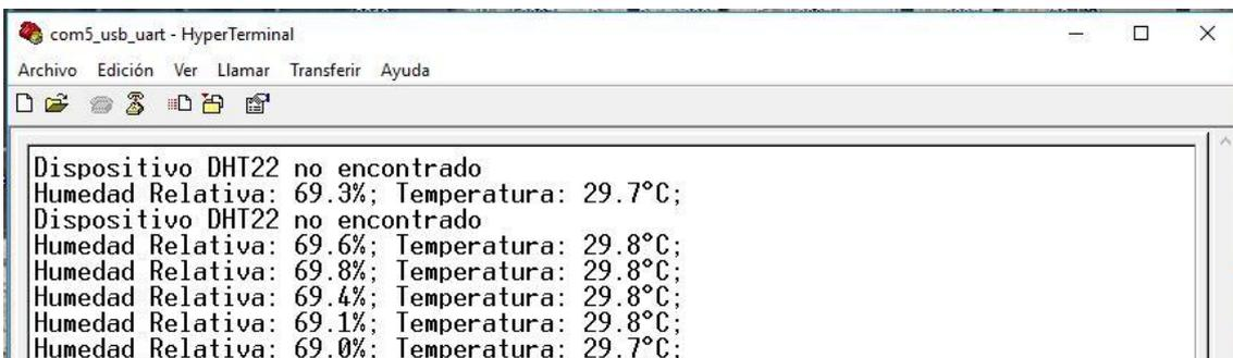
**Fig. 2.11** Recepción de datos de humedad y temperatura
