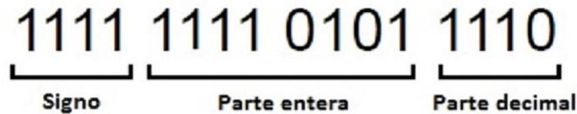
**Fig. 2.29** Formato de datos del sensor DS18B20
