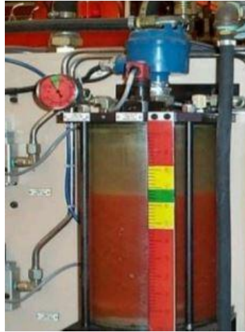
Figura 9. Exemple d'una eina de control visual. El nivell de colors ens permet ràpidament detectar si la quantitat de fluid en el cilindre és l'adequada ( Font: SIOM (2013) ).
