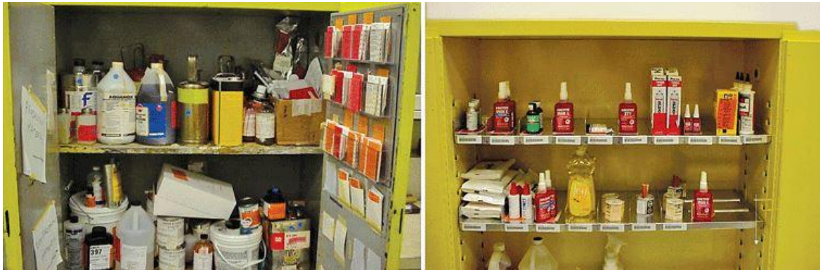
Figura 7. Una farmaciola, que pot representar qualsevol espai d'una empresa. A l'esquerra, l'abans, i a la dreta el després d'aplicar les 5S. ( Font: Total Quality Management (2016) )
