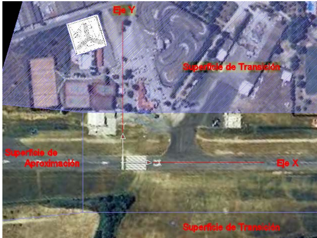
Fig. 4 Vista en planta de las servidumbres de la pista 35 para el escenario 2. Ortoimagen cortesía del Institut Cartogràfic de Catalunya (ICC).
