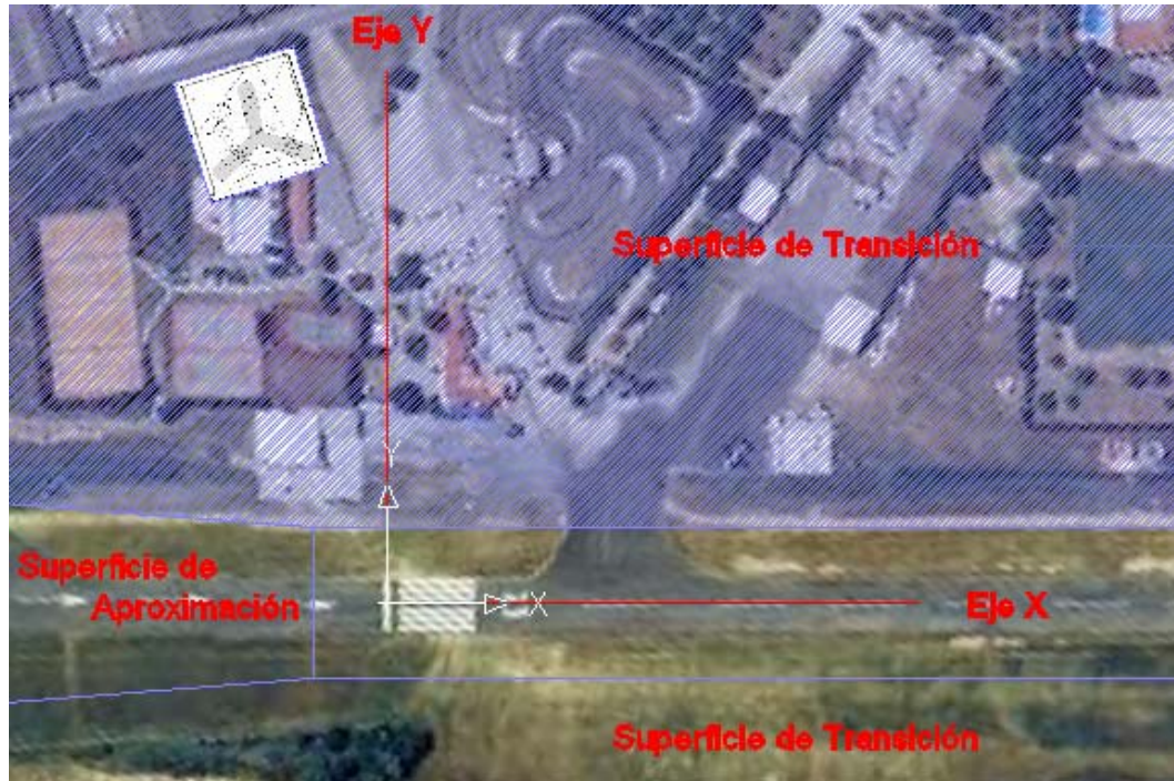
Fig. 4 Vista en planta de las servidumbres de la pista 35 para el escenario 1. Ortoimagen cortesía del Institut Cartogràfic de Catalunya (ICC).
