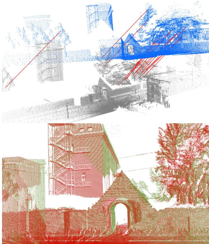
Figura 3.1: Resultado de aplicar la transformación obtenida de un registro sobre dos nubes de puntos
