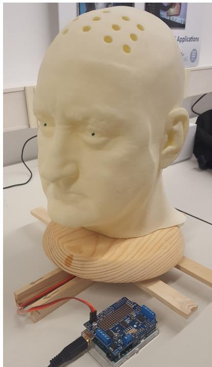
Figura 5.5: Plataforma giratoria con una cabeza 3D impresa mediante este-reolitografía
