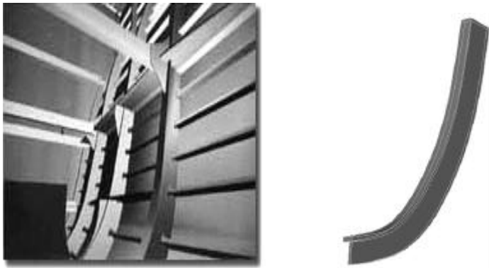
Figura 6: Ejemplo de cuadernas de un barco y su modelado utilizando la función de barrido
