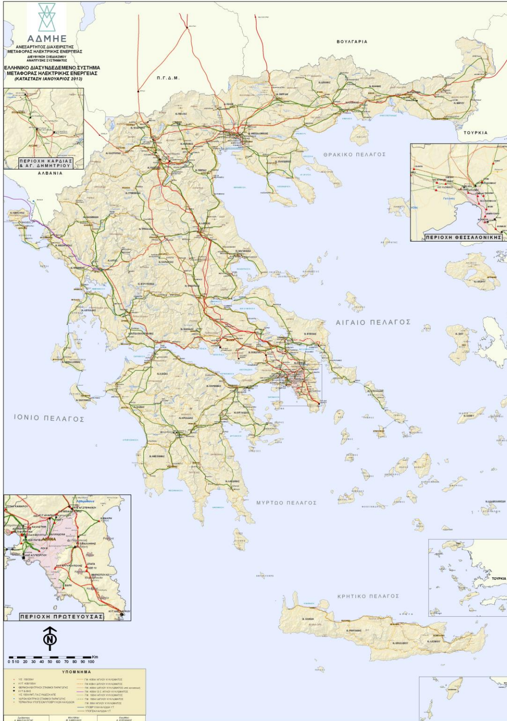
Σχήμα 2.1: Ελληνικό Δίκτυο Διανομής Ηλεκτρικής Ισχύος
