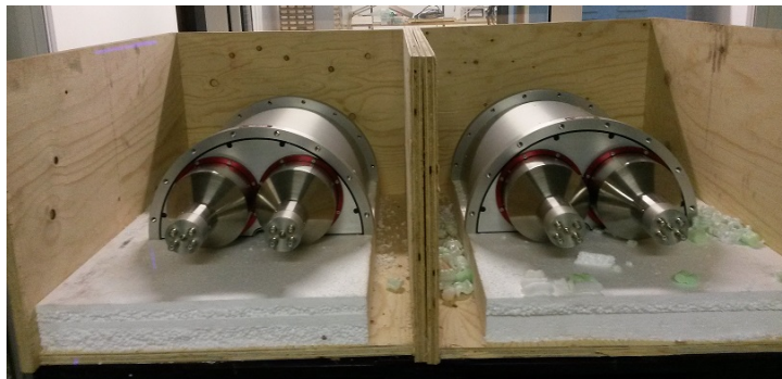
Σχήμα 3.7: Το καινούριο \gamma -Καλορίμετρο του Εργαστηρίου του Επιταχυντή Tandem στο Ινστιτούτο Πυρηνικής και Σωματιδιακής Φυσικής του ΕΚΕΦΕ "Δημόκριτος".
