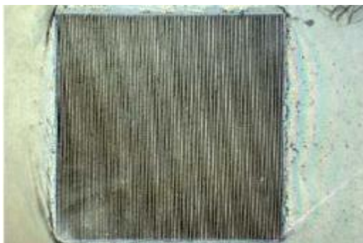
Σχήμα 1.10 Εικόνα μιας δομής grating ( 150 \times 150 \mu\text{m}^2 ) σε λεπτό μεμβράνη PDMS [6]
