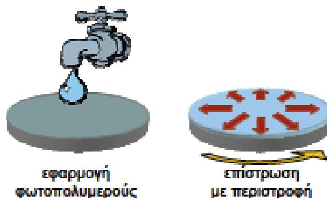
Σχήμα 3.10 Διαδικασία εφαρμογής και επίστρωσης του φωτοπολυμερούς
