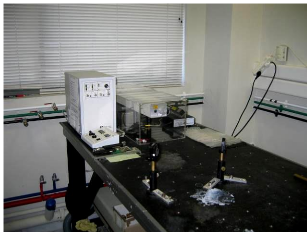
Σχήμα 2.1 Το Nd:YAG LASER και τα δύο κάτοπτρα που μεταφέρουν τη δέσμη του laser στο δεύτερο οπτικό τραπέζι
