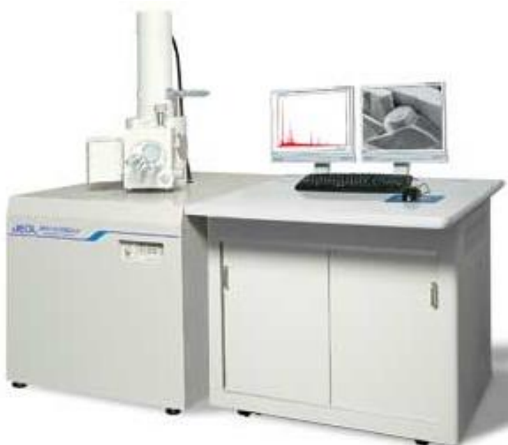
Σχήμα 4.2 Φωτογραφία της διάταξης ηλεκτρονικής μικροσκοπίας σάρωσης (SEM)
