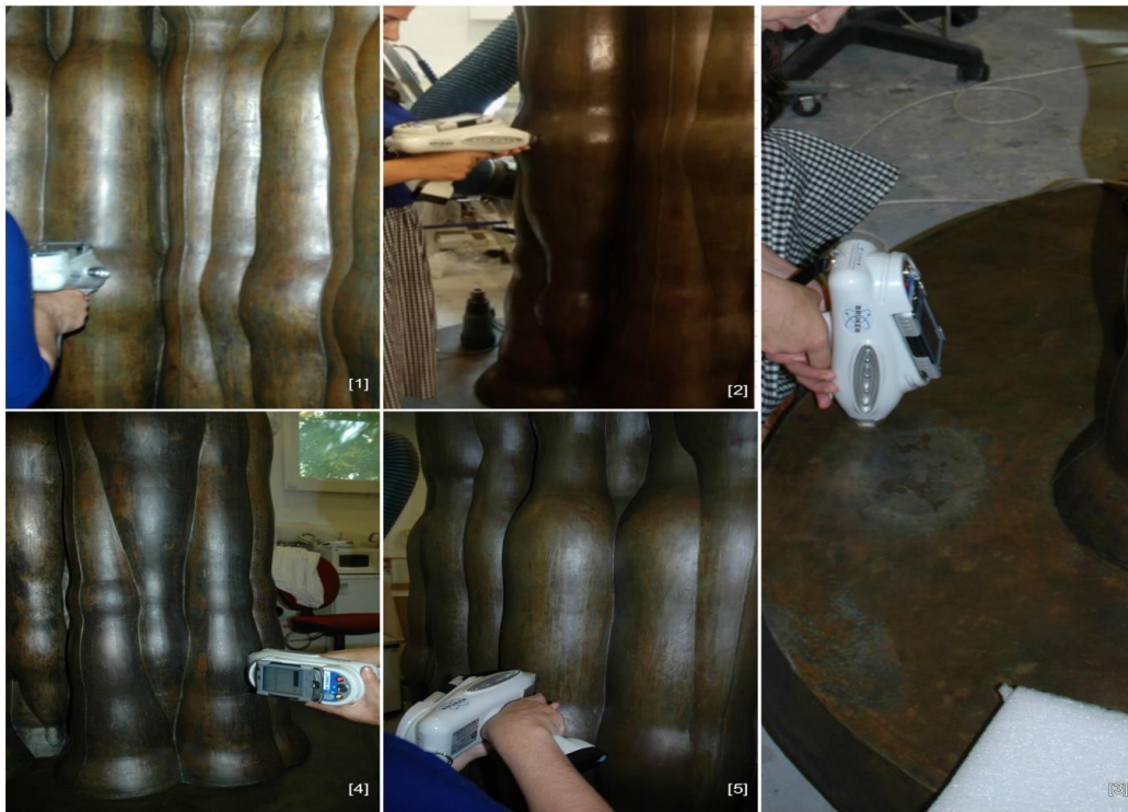
Εικόνα 97 Σημεία μετρήσεων με φορητό XRF στο έργο «Πόλις», μετά τον καθαρισμό (πριν την εφαρμογή κεριού)
