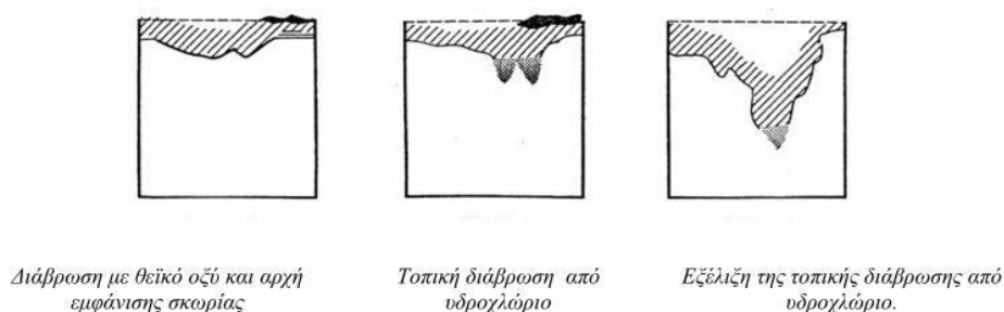
Σχήμα 7 Μηχανισμός διάβρωσης χάλκινων γλυπτών στον περιβάλλοντα χώρο [3]
