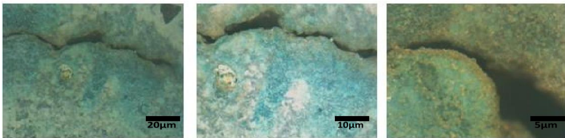
Εικόνα 93 Δείγμα R_2_1 ρωγμής και πράσινο-μπλε προϊόντων διάβρωσης-επικαθίσεων (πολωμένο φως)
