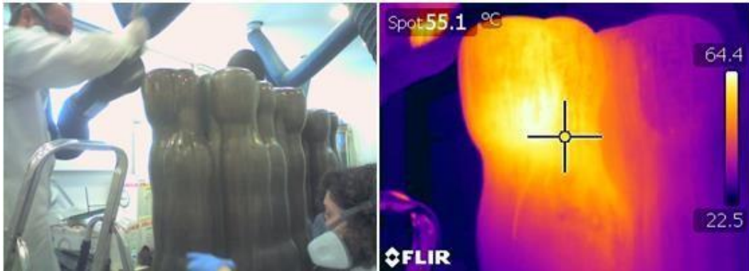
Θερμογράφημα 1 Τμήμα περιοχής του «Πόλις» κατά την επίστρωση του προστατευτικού κεριού (T=23°C, RH=44%). Η θερμοκρασία του μετάλλου έφτανε στους 60°C κατά την εφαρμογή του κεριού
