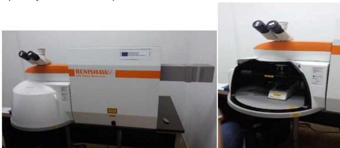
Εικόνα 20 Συσκευή φασματοσκοπίας μ-Raman που χρησιμοποιήθηκε για την ανάλυση
