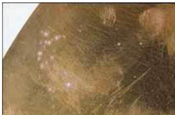
Εικόνα 7 Αποψευδαργύρωση ορείχαλκου (CCQ, Jérôme R. Morissette)[21]
