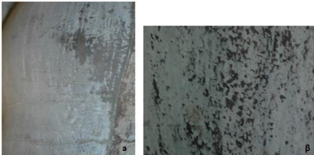
Εικόνα 64 Κατανομή υπόλευκης επικάλυψης στην μεταλλική επιφάνεια_1 α) Λεπτή στρώση λευκής με καλή επικαλυπτικότητα, β) παχιά στρώση λευκής κρούστας με μικρή συνεκτικότητα (κηλίδες)
