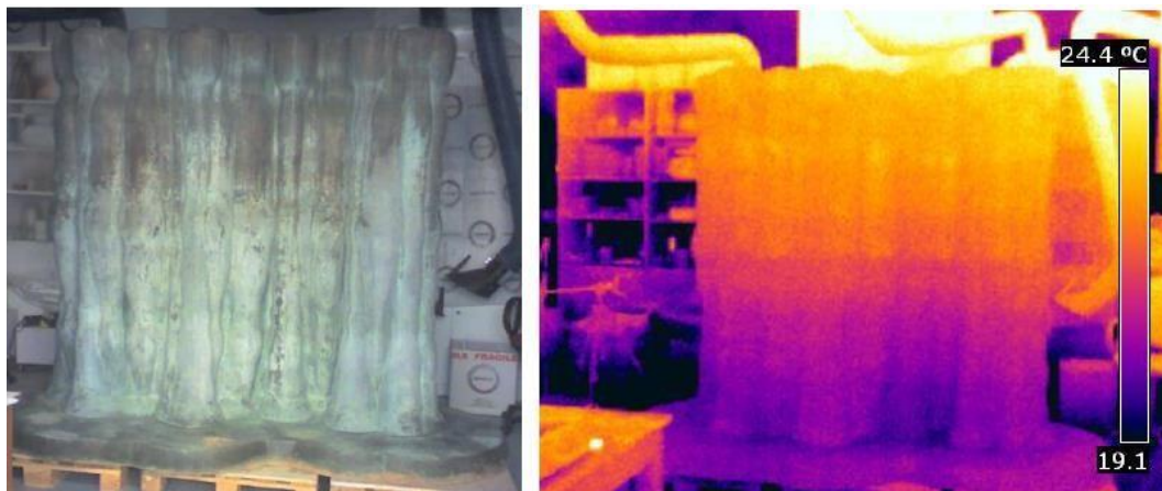
Θερμογράφημα 2 Παθητικός Θερμογραφικός έλεγχος νότιας όψης του «Πόλις», συνθήκες εργαστηρίου (T=21°C, RH=40%)
