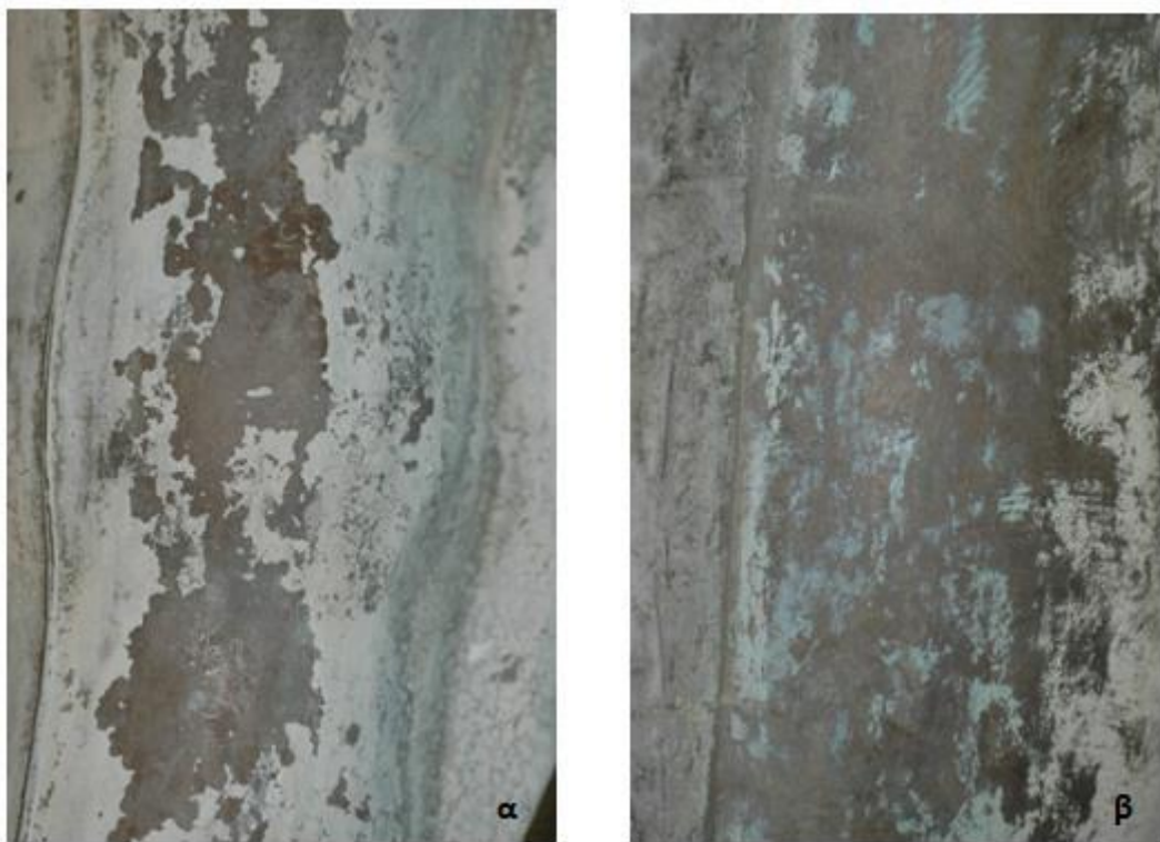
Εικόνα 65 Επικαλυπτικότητα λευκής επικάλυψης στην μεταλλική επιφάνεια_2 α) Αποκόλληση παχιάς λευκής κρούστας, και μπλε σημάδια στα λεπτά στρώματα αυτής, β) μπλε αποχρώσεις σε εξασθετισμένες λευκές κηλίδες
