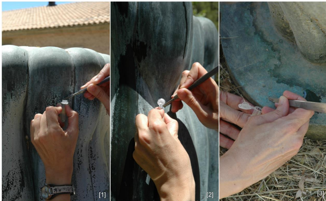
Εικόνα 113 Επικαθήσεις-προϊόντα διάβρωσης [1] δείγμα_1, [2] δείγμα_2, [3] δείγμα_3
