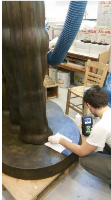
Εικόνα 100 Βαθμονόμηση οργάνου σε περιοχή κοντά στην βάση, όπου ήταν δυνατή η μέτρηση με μηχανικά μέσα.
