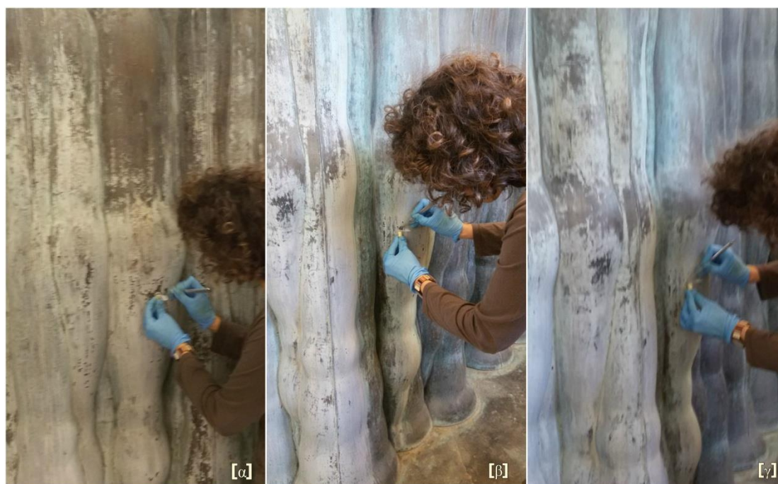
Εικόνα 107 Επικαθίσεις-προϊόντα διάβρωσης υπόλευκης απόχρωσης [α] Δείγμα 1, [β] Δείγμα 2, [γ] Δείγμα 3
