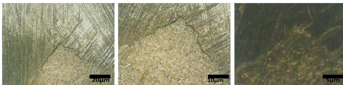
Εικόνα 70 Δείγμα B_5_1 από περιοχή διαφορετικής υφής της μεταλλικής επιφάνειας (μη πολωμένο φως)
