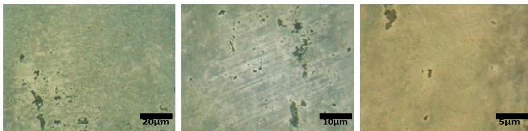
Εικόνα 61 Δείγμα F_4_2_Δ5 από υπόλευκη περιοχή (πολωμένο φως)
