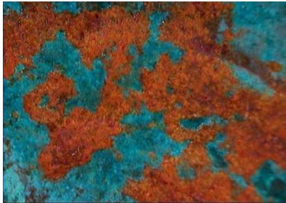
Εικόνα 8 Κυπρίτης ( \text{Cu}_2\text{O} )- καφέ χρώμα έως ροζ, διατηρεί λεπτομέρειες της αυθεντικής επιφάνειας (Εργαστήριο Συντήρησης Μεταλλικών Αντικειμένων-ΤΕΙ ΑΘΗΝΑΣ)
