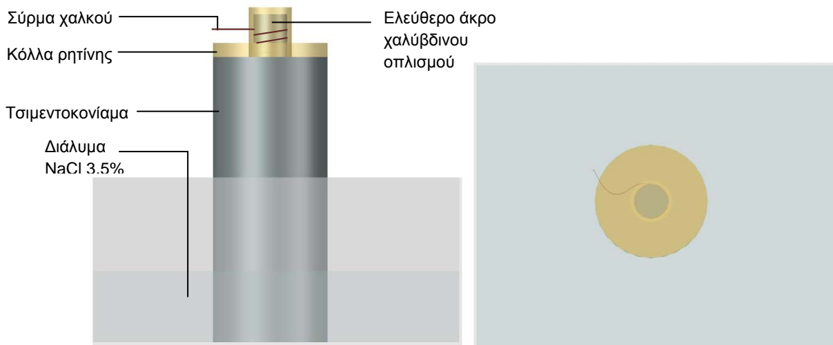
Εικόνα 7. Σχηματική παράσταση ενός δοκιμίου σε όψη και κάτοψη
