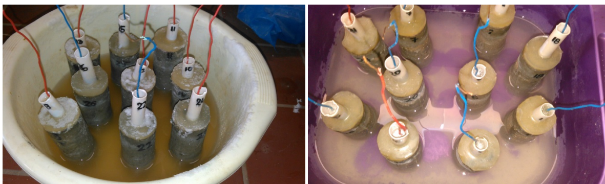
Εικόνα 9. Τα δοκίμια των ομάδων 2 και 4 (αριστερά) και των ομάδων 2 και 3 (δεξιά) έπειτα από 6 μήνες έκθεσης στο διάλυμα NaCl.
