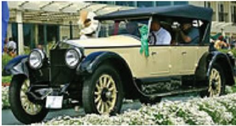
Σχήμα 1.3: Το Owen Magnetic Model 60 Touring του 1921 χρησιμοποιεί βενζινοκινητήρα για να κινεί γεννήτρια η οποία παρέχει ηλεκτρικό ρεύμα σε δυο μοτέρ που βρίσκονται τοποθετημένα στον καθένα από τους πίσω τροχούς.
