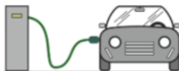
Σχήμα 4.7: Σύνδεση ηλεκτρικού οχήματος τύπου C
