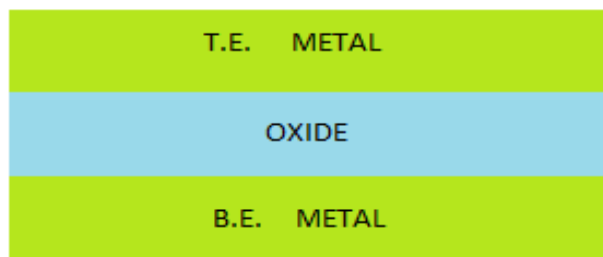
Εικ. 2: Τυπική διάταξη RRAM όπου διακρίνεται η άνοδος (Top Electrode), η κάθοδος (Bottom Electrode) και ανάμεσα τους το μονωτικό υλικό.
