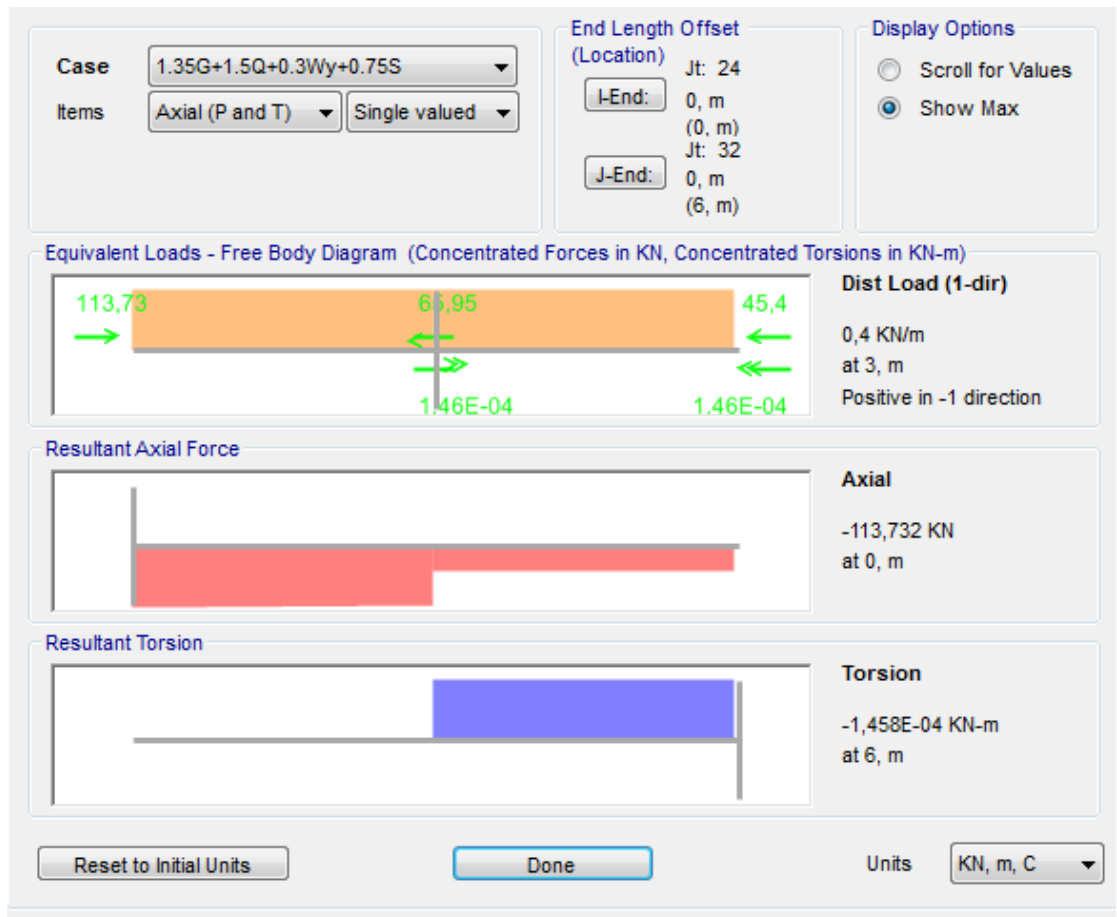
Σχ. 5.7. Μέγιστη αξονική δύναμη στο μεσαίο υποστύλωμα
