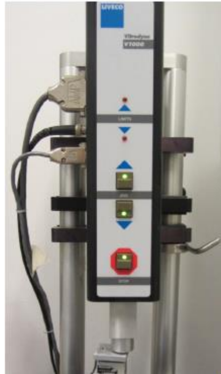
Εικόνα 2.1.4α: Αποτυπώνεται το πάνω μέρος της συσκευής. Διακρίνεται το έμβολο κίνησης (κάτω μέρος) καθώς και η μηχανική διάταξη για τη λήψη και την αποστολή των δεδομένων του πειράματος στον Η/Υ. Βλέπουμε επίσης και τις διατάξεις για την αρχική ρύθμιση της απόστασης.
