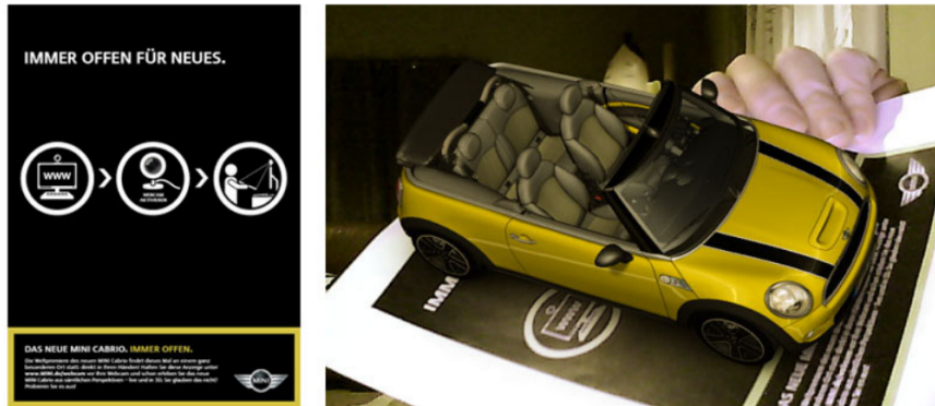
Εικόνα 22: Παράδειγμα χρήσης AR με Marker based συστήματα στον τομέα της διαφήμισης. (Πηγή: technabob.com)
