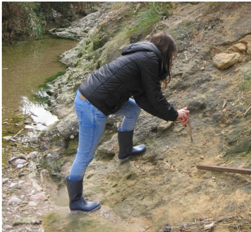
Εικόνα 3-2: Χρήση της σφύρας Schmidt στο ύπαιθρο
