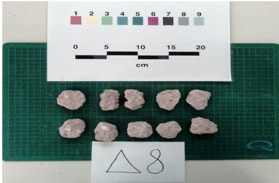
Εικόνα 4-31: διαμορφωμένα δοκίμια του Δείγματος 8 για τη δοκιμή διαβρωσιμότητας
