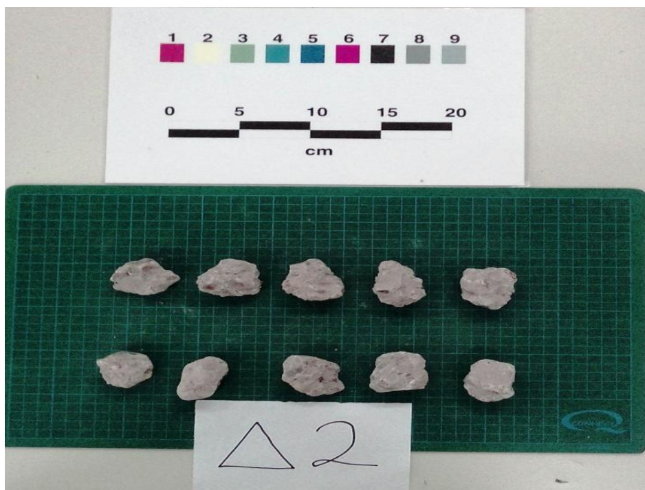
Εικόνα 4-7: διαμορφωμένα δοκίμια του Δείγματος 2 για τη δοκιμή διαβρωσιμότητας
