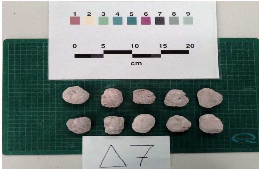
Εικόνα 4-27: διαμορφωμένα δοκίμια του Δείγματος 7 για τη δοκιμή διαβρωσιμότητας
