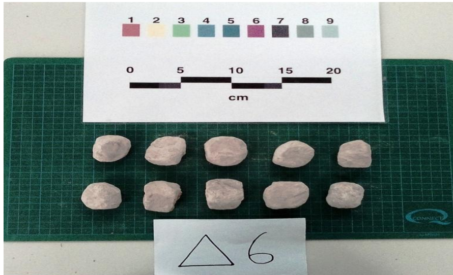
Εικόνα 4-23: διαμορφωμένα δοκίμια του Δείγματος 6 για τη δοκιμή διαβρωσιμότητας
