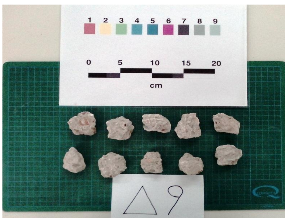
Εικόνα 4-35: διαμορφωμένα δοκίμια του Δείγματος 9 για τη δοκιμή διαβρωσιμότητας
