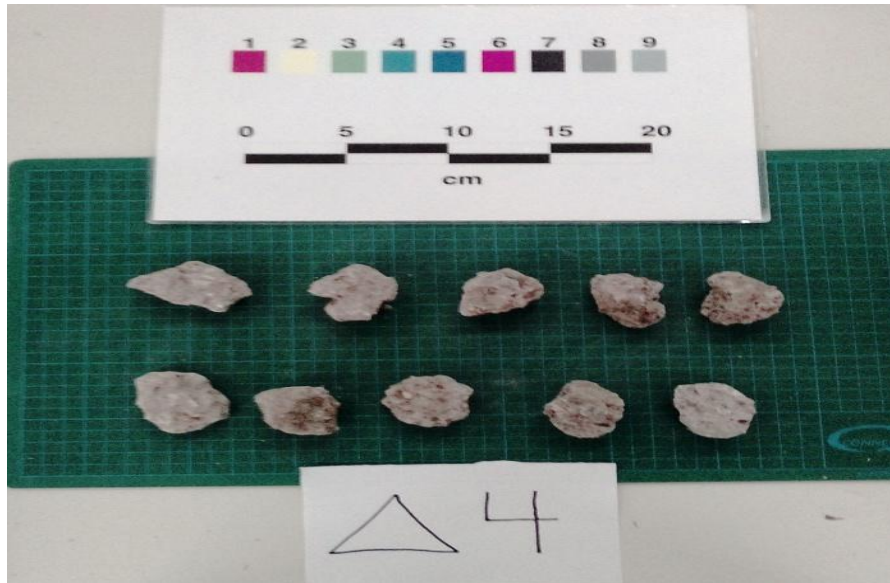
Εικόνα 4-15: διαμορφωμένα δοκίμια του Δείγματος 4 για τη δοκιμή διαβρωσιμότητας
