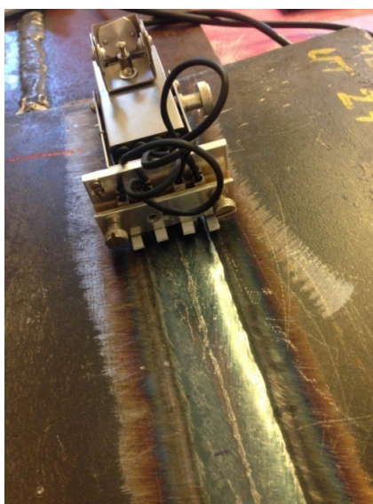
Slika 3.1.2 Uređaj za skeniranje na UT27 uzorku. Razmak između senzora je 12 mm zbog veće širine zavara. Rubni senzori su postavljeni na ZUT, a središnji na zavar
