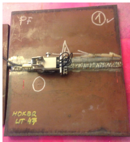
Slika 3.1.4 Način skeniranja zavarenog spoja – uzdužno. Lijeva oznaka crvenom kredom je početak skeniranja (cca. 40 mm od ruba) kako bi kotač uređaja za skeniranje bio na uzorku radi mjerenja puta preko enkodera, a desna oznaka crvenom kredom je kraj skeniranja radi izbjegavanja rubnog efekta
