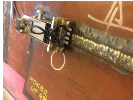
Slika 2.2 Uređaj za skeniranje SD-1 (univerzalna namjena) s 4 senzorska modula koji svaki mjeri magnetno polje u smjeru Y (normala na ispitni objekt) i X komponentu (u smjeru skeniranja). Uređaj ima kotače za mjerenje udaljenosti, podesiv razmak senzora ovisno o vrsti skeniranog objekta kao i podesivu udaljenost senzora od ispitnog objekta
