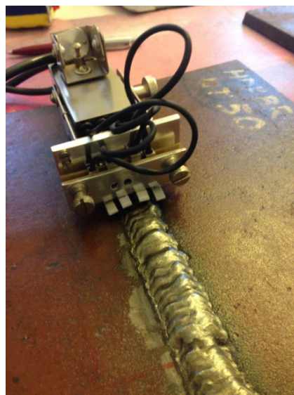
Slika 3.1.3 Uređaj za skeniranje na UT50 uzorku. Zbog izraženije krune zavara, senzori su podešeni da prate zakrivljenost krune s time da su rubni senzori postavljeni na ZUT, a središnji na zavar i sam razmak između senzora je 7 mm
