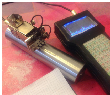
Slika 3.1.5 Skeniranje uzorka UT30. U praksi na ekranu instrumenta, operater može odmah vidjeti distribuciju magnetnog polja, udaljenost i gradijent, te označiti ta područja za daljnja ispitivanja. Zbog toga se metoda MMM smatra brzom metodom
