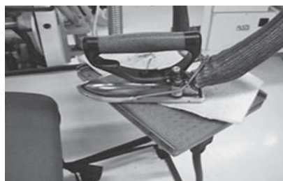
Sl.6 Postavljanje netkanog tekstila ispod ploče glačala
