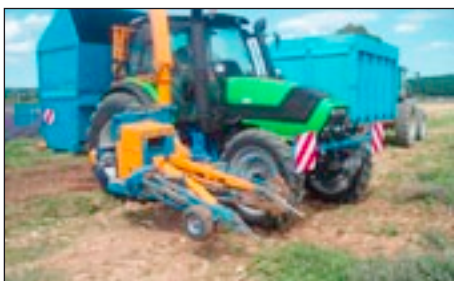
Slika 9. Traktorski berač za ubiranje i usitnjavanje lavande (Clier)
