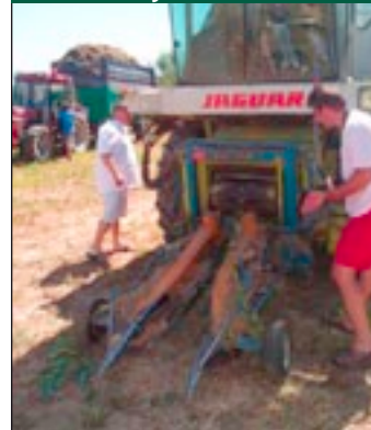
Slika 12. Traktorski priključak za ubiranje i vezanje lavande u snopove
