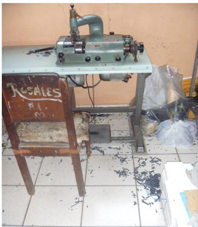
Foto #03: Falta de limpieza en el área de desbastado
