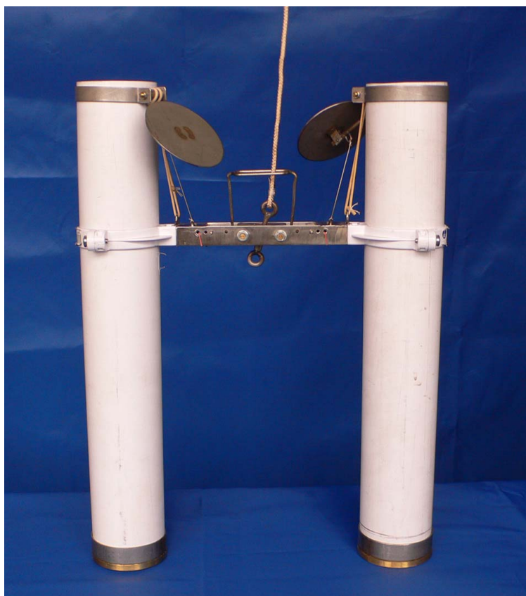
Рис. 1. Седиментационная ловушка типа Håkanson (1984) с крышками. В оригинале без крышек. Фото авторов
