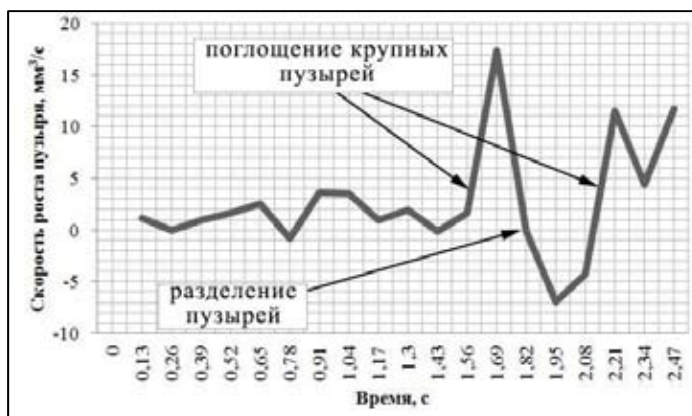
Рис. 9. Зависимость скорости роста пузыря от времени (ячейка 1, 0,05 А/см²)
