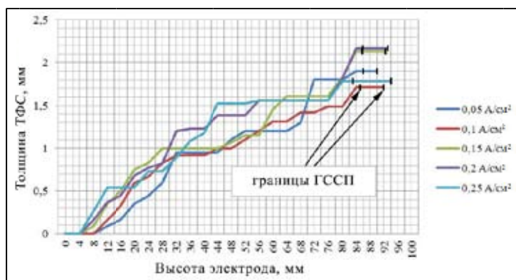
Рис. 11. Зависимость толщины ТФС от высоты при разных плотностях тока (ячейка 2)
