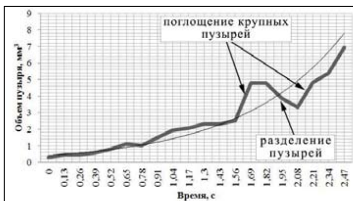
Рис. 8. Зависимость объема пузыря от времени (ячейка 1, 0,05 А/см 2 )
