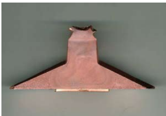
Рис. 3. Макрошлиф медного темплета в объеме расширяющейся форкамерной матрицы
