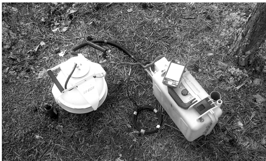
Рис. 3. Инфракрасный газоанализатор LI-COR (LI-8100)
