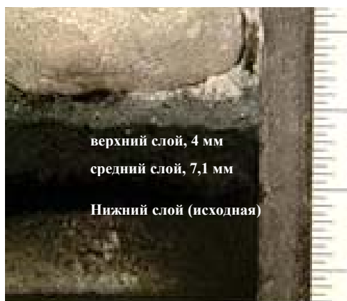
Рис. 3. Вид образца из смеси полукокса бурого угля и шамота после 20-часовых испытаний на криолитоустойчивость
