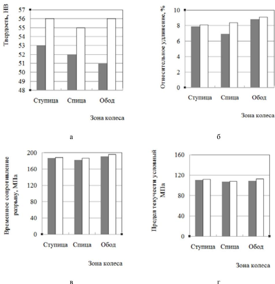
Рис. 4. Зависимость механических свойств дисков колес, изготовленных из опытных сплавов № 2 и № 3 от соотношения в их составе Fe : Mn: а – твердость по Бринеллю; б – относительное удлинение; в – временное сопротивление разрыву; г – предел текучести условный. Соотношение Fe : Mn: ■ – 1 : 0,5 (сплав № 2); □ – 1 : 1 (сплав № 3)
