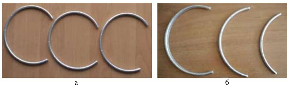
Рис. 1. Пробы жидкотекучести сплава АК12 в зависимости от нанесенного покрытия: а – серийное D1; б – разработанное КП80
