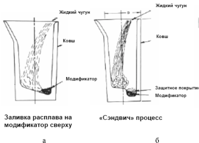
Рис. 5. Примеры ковшей для модифицирования методами а – заливки расплава на модификатор; б – «сэндвич»-процесса
