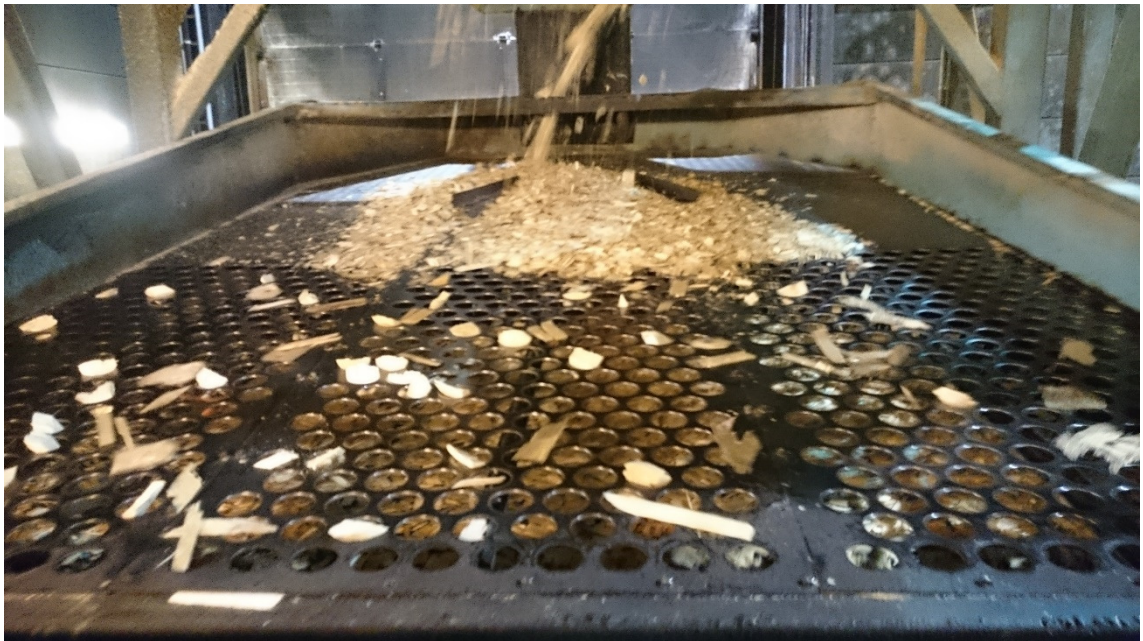
Kuva 9. Tasoseulaan asennettu peitelevy näkyy seulan yläpäässä. (kuva: Henri Karvinen)
