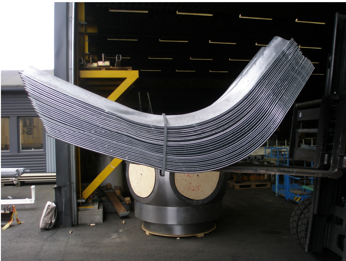
Kuva 13 Monilevyjen purkua merikontista. Monilevyt rahdataan pakkoina, joka tekee niiden kuljetuksesta erittäin kustannustehokasta.
