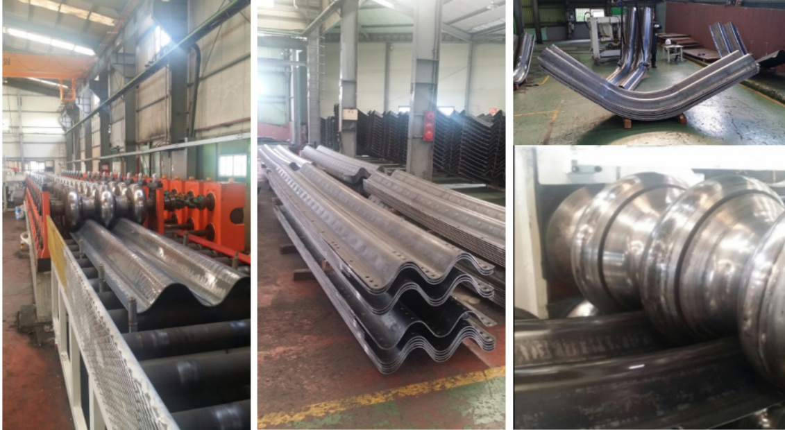
Kuva 12 Monilevyjen valmistusta tehtaalla. (Rexsteel.)
