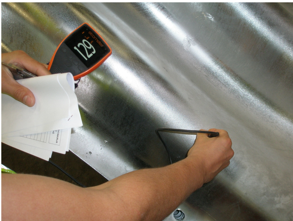
Kuva 14 Monilevyn sinkkipinnoitteen paksuuksia mitattiin pistokoemaisesti.
