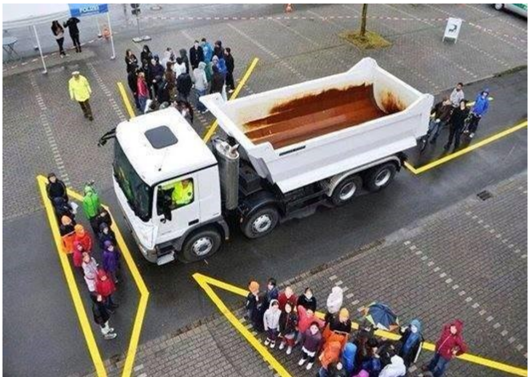
Kuva 8 Kuorma-auton katvealueet (Lappalainen, 2015).
